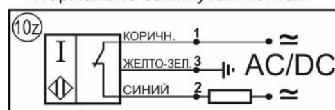
Цоколевка клеммной колодки
