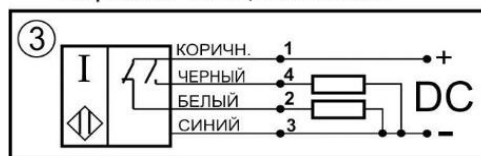
Схема соединения Переключающий контакт
